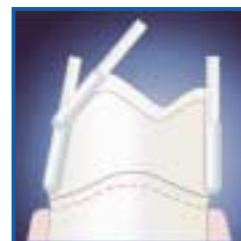
Axiale Reduktion der anatomischen Form um mindestens 1 mm. Axial substance reduc- tion at least 1 mm.
